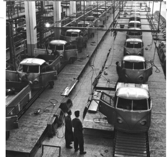
Die Endmontage im neuen Volkswagenwerk in Hannover war lichtdurchflutet, die Arbeitsplätze waren ergonomisch gestaltet – zum Teil mit Hochbändern – und die Anlieferungswege für das Produktionsmaterial breit: optimale Arbeitsbedingungen in jener Zeit. (Foto: Volkswagen AG)
